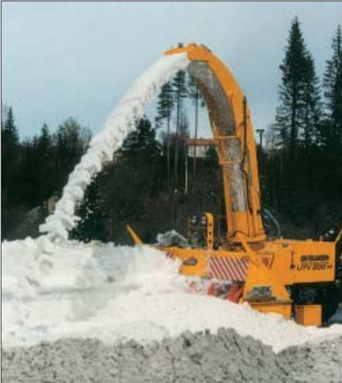
UTV 200 H med kombinasjonstut. UTV 200 H with combichute.
